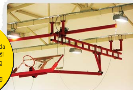
KOŠ KONSTRUKCIJA HORIZONTALNO POMIĆNA
